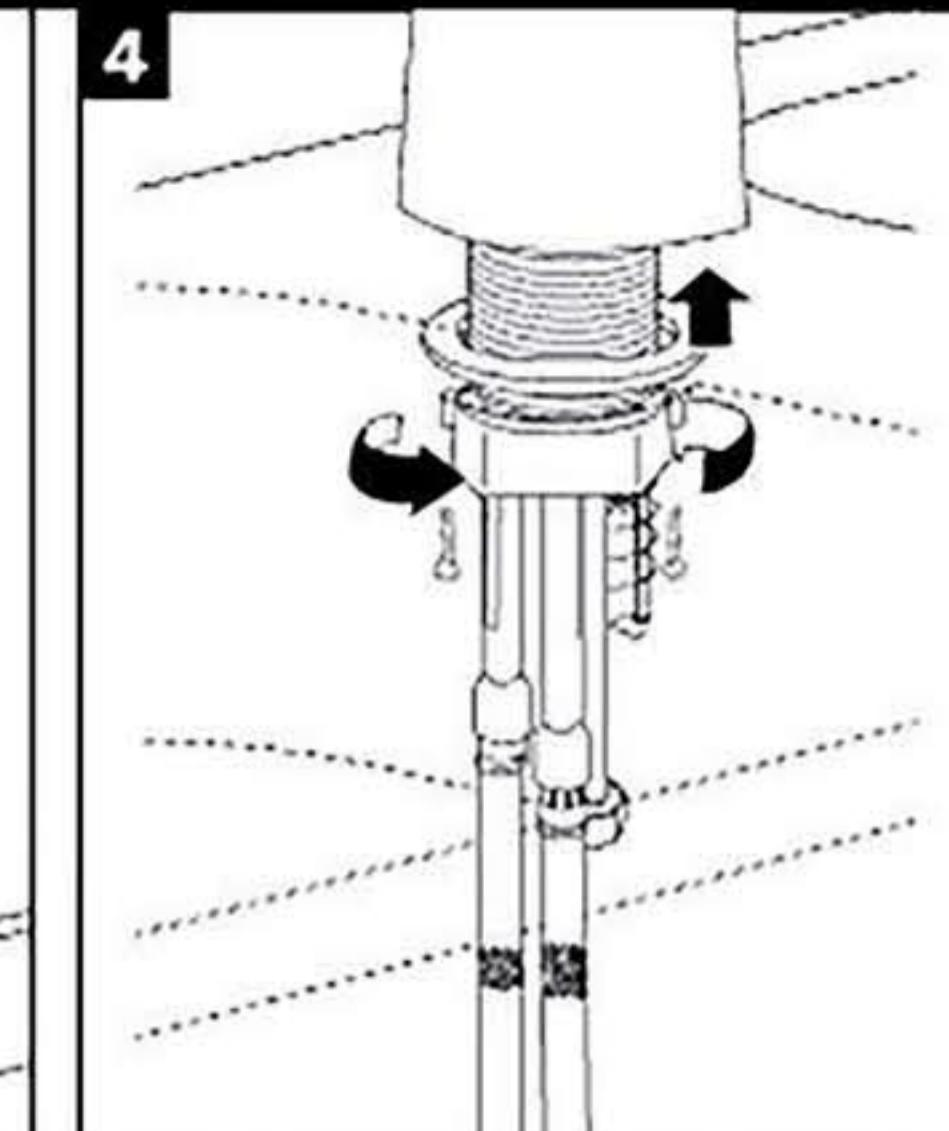
4. Por debajo del lavaplatos posicione la arandela metálica en el tubo roscado y fije la grifería por medio de la tuerca de conexión de rápida instalación . Posteriormente realice el ajuste final por medio de los tornillos.
