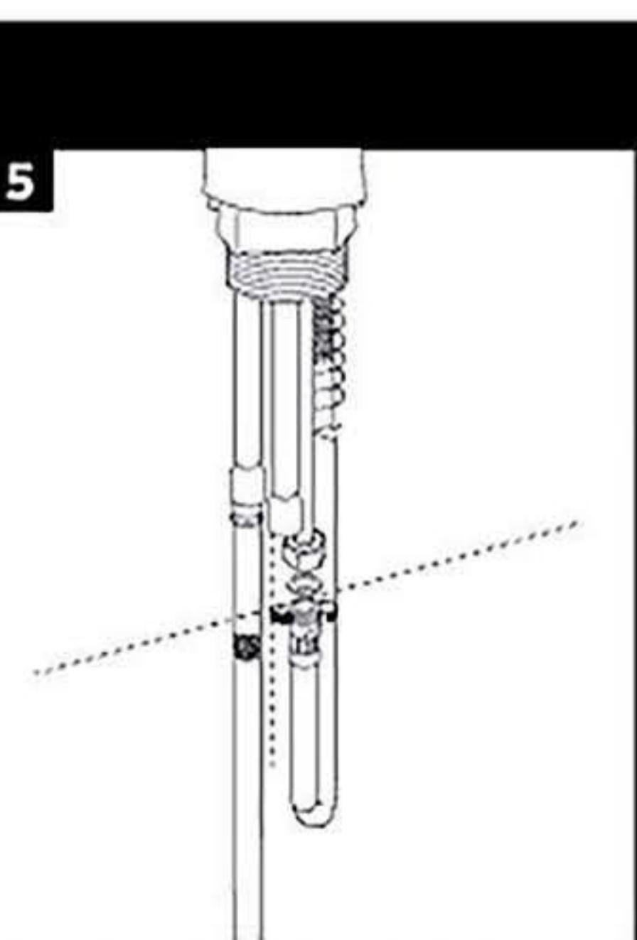
5. Asegúrese que está posicionada una goma plana de sellado en el interior de la tuerca del tubo sobrante y posteriormente, conecte el flexible de abastecimiento del extraíble a él.
