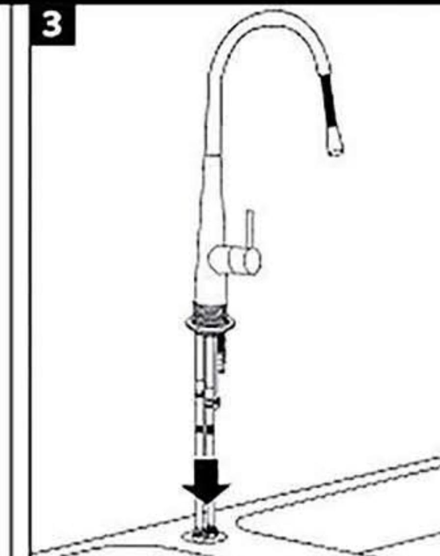
3. Introduzca los flexibles de abastecimiento de agua y el flexible del extraíble por el orificio del lavaplatos. Asegure la correcta posición de la goma de sellado en la base de la grifería, para evitar filtraciones de agua hacia el interior del lavaplatos.
