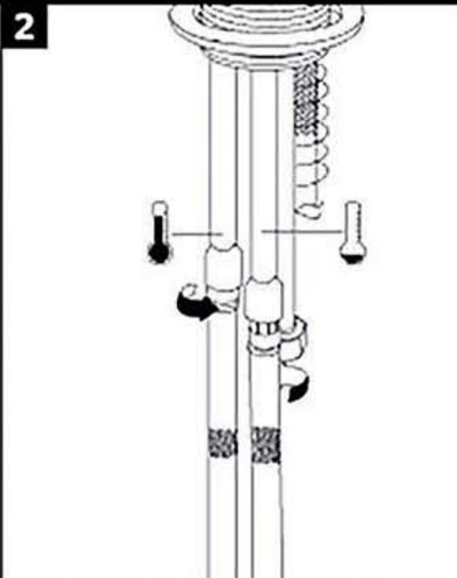
2. Conecte los flexibles de agua fría y caliente, enroscándolos a los pasados a través de los tubos correspondientes. Fíjelos con un apriete final utilizando una herramienta de ajuste.
