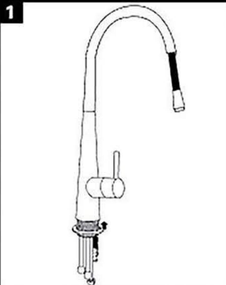
1. Posicione la goma plana de sello en la base de la grifería, fría y caliente, enroscándolos a los pasándola a través de los tubos correspondientes. Fíjelos flexibles y el tubo roscado.
