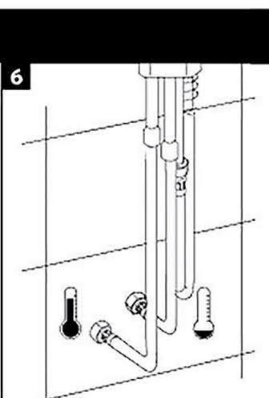
6. Conecte los flexibles de abastecimiento de agua fría y caliente a los terminales del muro correspondientes. Realice un apriete final de aproximadamente 1/4 de giro a las tuercas de los flexibles.
