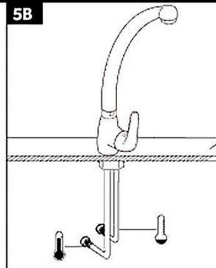
4B. Por debajo del lavaplatos positione la arandela metálica en el tubo roscado y fije la grifería por medio de la tuerca de conexión de rápida instalación. Posteriormente realice el ajuste final por medio de los tornillos.
