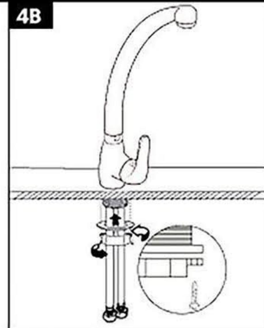
4B. Por debajo del lavaplatos 5B. Conecte los flexibles a la posicione la arandela metálica en toma de agua correspondiente el tubo roscado y fije la grifería por (terminales del muro HE) medio de la tuerca de conexión de rápida instalación . Posteriormente realice el ajuste final por medio de los tornillos.
