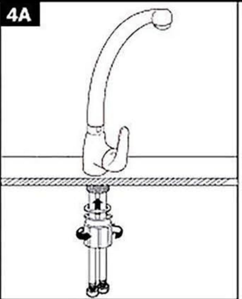
4A. Por debajo del lavaplatos 5B. Conecte los flexibles a la posicione la arandela metálica en toma de agua correspondiente el tubo roscado y fije la grifería por (terminales del muro HE) medio de la tuerca de conexión de rápida instalación.
