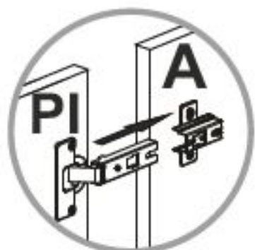
INSTALACIÓN BISAGRA/ Hinge Installation
