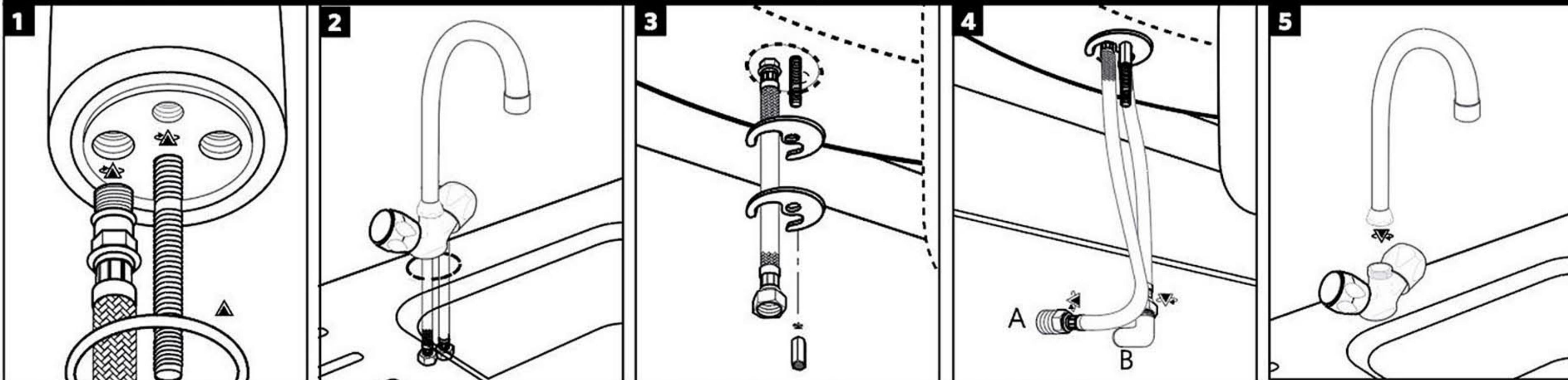
1. Fije manualmente los flexibles y espárragos a la conexión correspondiente ubicada en la parte inferior de su grifería. A su vez, posiciones el O'ring de goma en la cavidad dispuesta en la base.
