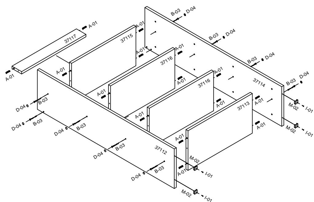
**Paso 3:** Fijar las piezas del cajón utilizando tarugos y tornillos. Fijar lo tirador con tornillos **B-04**.
