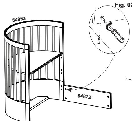
4) Fijar la segunda cabecera / peseira (54863) a los importes inferiores (54872), utilizando el minifix rosca magnifica "G" y "H". Gire los tambores minifix presionando según fig. 03.
