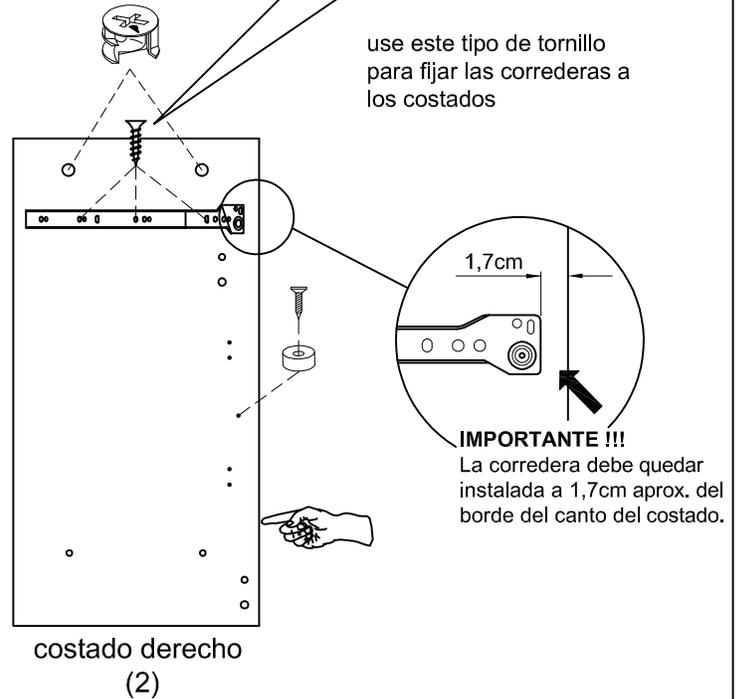
Presente las correderas sobre los costados, dejándolas a 1,7cm aprox. del canto enchapado de las piezas, como se indica. Antes de fijarlas, asegúrese que coincidan tres perforaciones de la corredera en el costado. Utilice los tornillos disponibles para fijarlas (destacados en el detalle superior).
