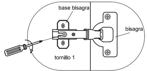
Regule y ajuste la posición de la puerta, aflojando y apretando el tornillo 2, como se muestra en las figuras.
