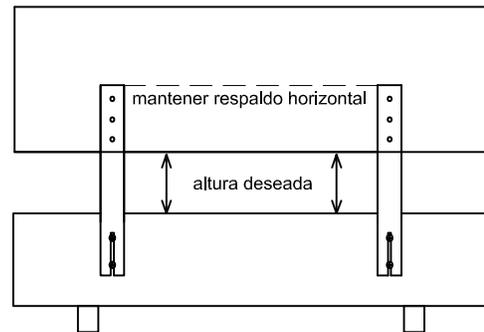
**3** A través de cada pata, marque con un lápiz, un clavo o algo con punta, las 3 perforaciones para tornillo de cada una, como se muestra en la figura.
