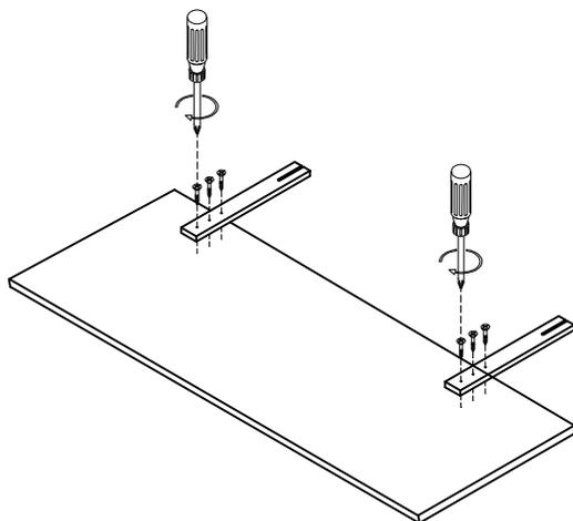
**6** Finalmente, fije el conjunto a la base de Cama Americana, atornillando los 4 pernos a la base (2 por cada pata) y utilizando las golillas entre perno y pata, como indica el dibujo.
