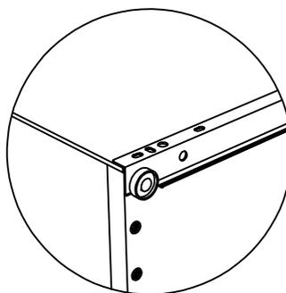
use este tipo de tornillo para fijar las guía de correderas a los costados de cajón
