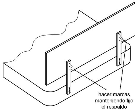
**4** Coloque el respaldo sobre una superficie horizontal, con las marcas hacia arriba. Utilizando martillo y clavo, agrande las marcas hechas en el respaldo, haciéndolas levemente más grandes y profundas, pero teniendo la precaución de no atravesar el tablero (el clavo no debe asomar hacia la cara).
