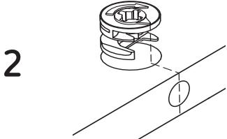
Debes insertar las cajas minifix con la flechita apuntando hacia la perforación que hay en el borde de la pieza.
