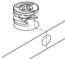
Debes insertar las cajas minifix con la flechita apuntando hacia la perforación que hay en el borde de la pieza.
