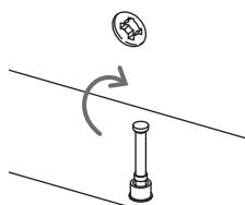
Luego de unir las piezas, debes girar 180° las cajas minifix con un destornillador de estrella para ajustar y asegurar el
