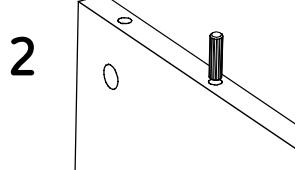
Antes de insertar cada tarugo, pon una gota de pegamento en la perforación.
