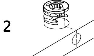
Debes insertar las cajas minifix con la flechita apuntando hacia la perforación que hay en el borde de la pieza.
