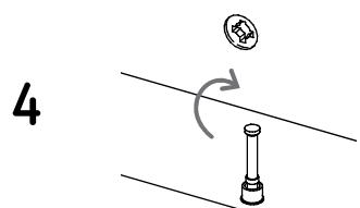
Luego de unir las piezas, debes girar 180° las cajas minifix con un destornillador de estrella para ajustar y asegurar el ensamble.
