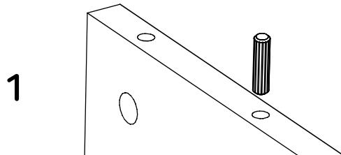
Inserta el tarugo en la perforación indicada y golpéalo suavemente hasta que llegue hasta el final de la perforación.
