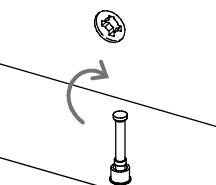
Luego de unir las piezas, debes girar 180° las cajas minifix con un destornillador de estrella para ajustar y asegurar el ensamble.
