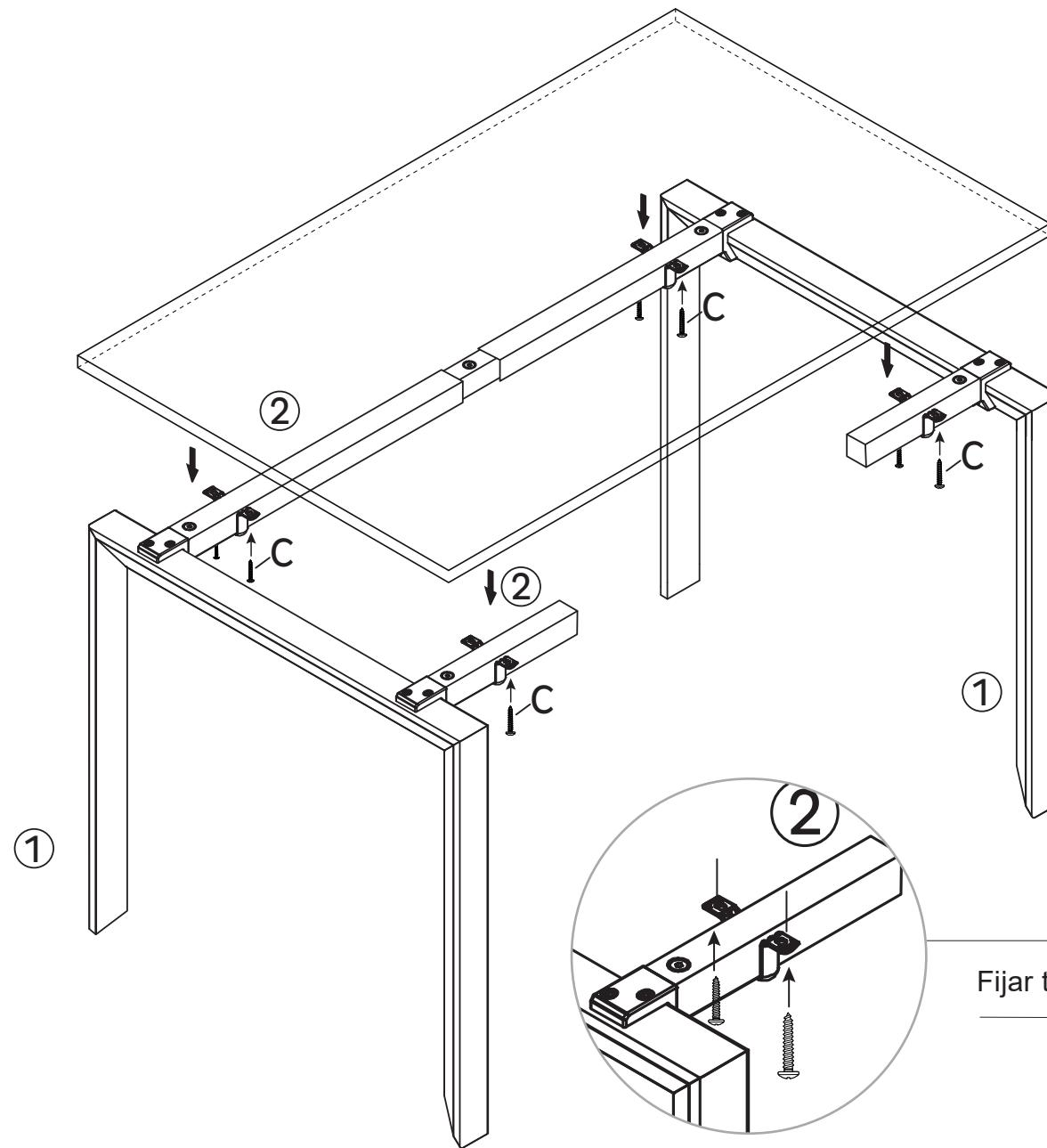
Fijar tornillos a la cubierta
