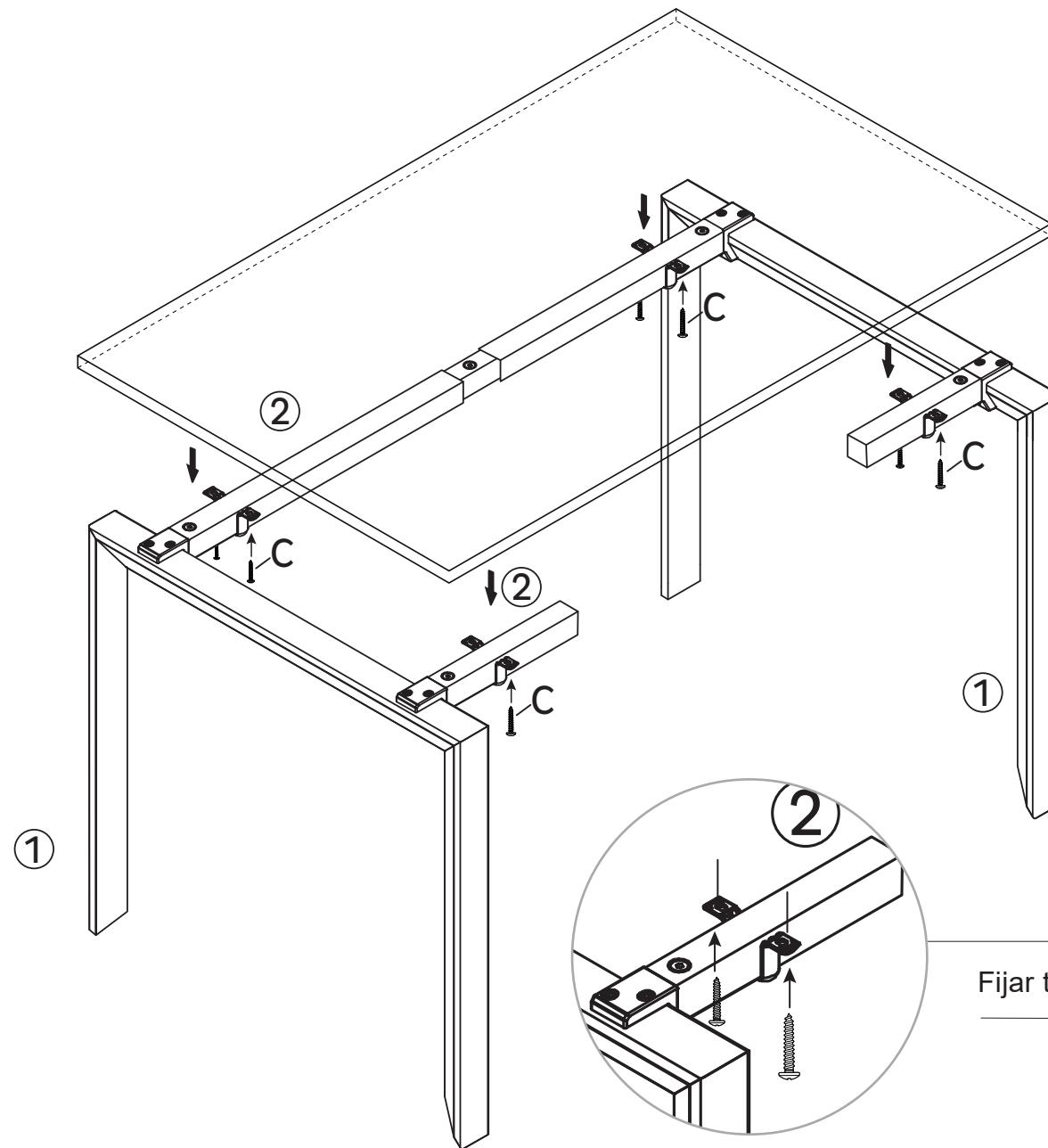
Fijar tornillos a la cubierta
