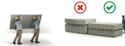
Para un correcto almacenamiento de las planchas mientras no se vayan a utilizar, se recomienda ubicarlas bajo techo en posición horizontal, sobre superficies niveladas para evitar deformaciones, en un lugar seco, evitando el contacto con el suelo y la lluvia.
