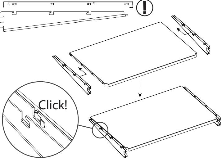
Verificar alineación de pestañas de la Bandeja en ranuras de los Sop. Graduables 37cm.
