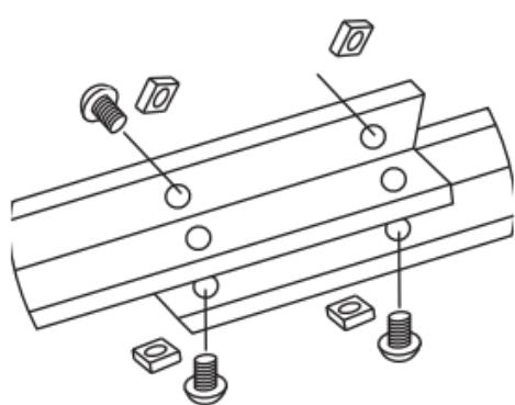
Superponga dos perfiles angulares y mediante los dos orificios y atornílelos firmemente, como se muestra en la ilustración. Siga este procedimiento con los otros seis perfiles angulares.
