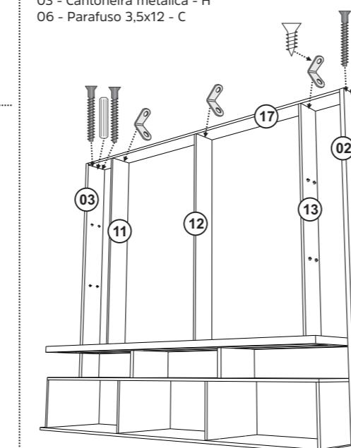
Fixar a peça 17 nas peças 02 e 03 com Parafuso 5x50 e Cavilha e nas peças 11, 12 e 13 com Cantoniera metálica e Parafuso 3,5x12.
