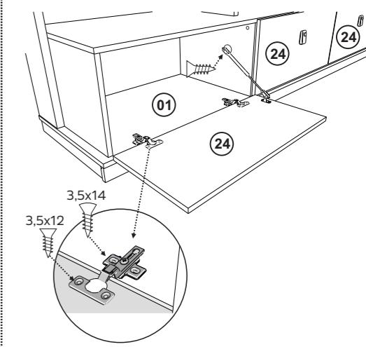
Fixar as Dobradiças nas peças 24 com Parafuso 3,5x12 e na peça 01 com Parafuso 3,5x14. Fixar o Pistão nas peças 04, 05, 06 e 24 com Parafuso 3,5x12.
