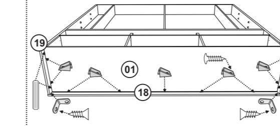
Fixar as peças 19 na peça 01 com Cavilha e Suporte angular. Fixar a peça 18 na peça 01 com Suporte angular e nas peças 19 com Cantoneira metálica. Fixar as Cantoneiras com Parafuso 3,5x12 e os Suportes angulares com Parafuso 3,5x12 flangeado.
