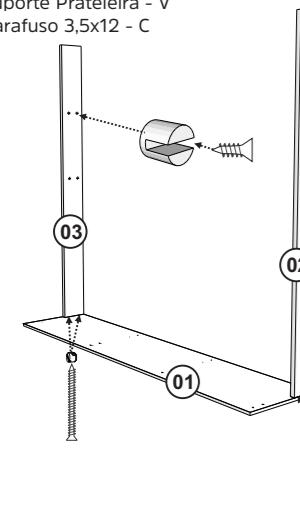
Fixar as peças 02 e 03 na peça 01 com Parafuso 4x50 com bucha. Fixar os Suportes de prateleira nas peças 02 e 03 com Parafuso 3,5x12.
