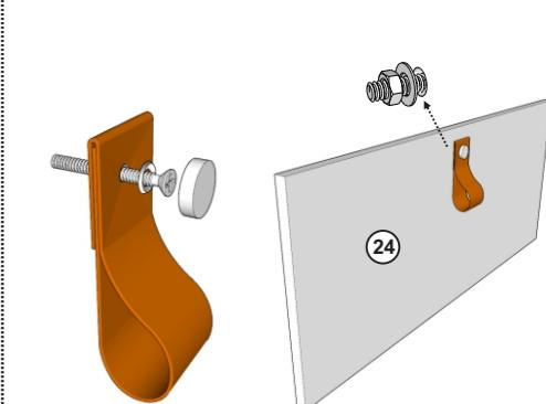
Dobrar a fita de Couro e encaixar o Parafuso 4x30 e fixar a Tampa no Parafuso. Prender o Parafuso nas portas 24 com arruela e porca.
