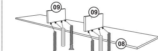
Fixar as peças 09 na peça 08 com Cavilha 6x30 e Parafuso 5x50.
