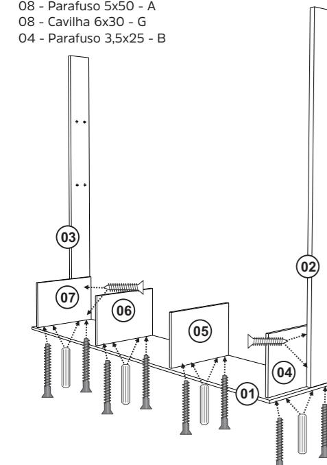
Fixar as peças 04, 05, 06 e 07 na peça 01 com Cavilha 6x30 e Parafuso 5x50. Fixar a peça 07 na peça 03 e peça 04 na peça 02 com Parafuso 3,5x25.
