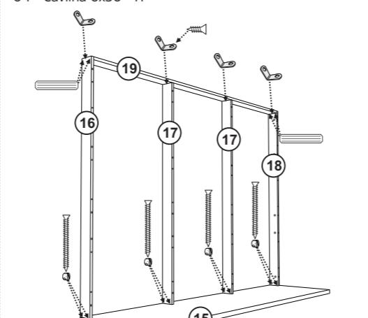
Fixar as peças 16, 17 e 18 na peça 15 com Parafuso 4x50 com Bucha. Fixar a peça 19 nas peças 16, e 18 com Cavilha e Cantoneira metálica e nas peças 17 com Cantoneira metálica e Parafuso 3,5x12.
