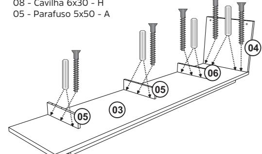
Fixar as peças 04, 05 e 06 na peça 03 com Cavilha e Parafuso 5x50.
