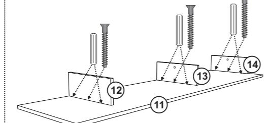
Fixar as peças 12, 13 e 14 na peça 11 com Parafuso 5x50 e Cavilha.
