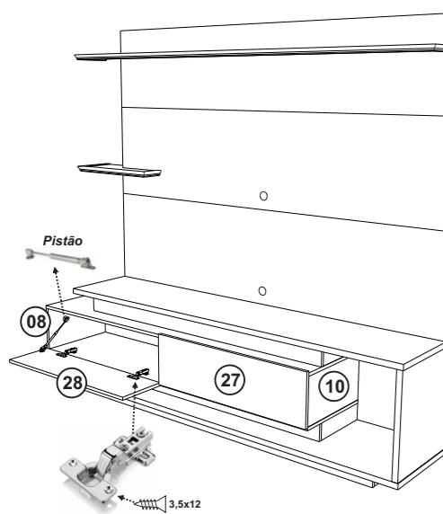
Fixar as peças 27 e 28 nas peças 08 e 10 com Pistão e Parafuso 3,5x12 e fixar na peça 07 com Dobradiça e Parafuso 3,5x12.
