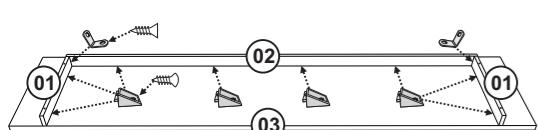
Fixar as peças 01 e 02 na peça 03 com Suporte angular e Parafuso 3,5x12 flangeado. Fixar as Cantoneiras metálicas nas peças 01 e 02 com Parafuso 3,5x12 chato.
