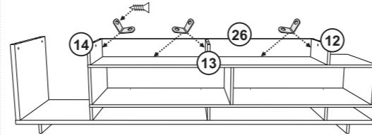
Fixar a peça 26 nas peças 12, 13 e 14 com Cantoneira metálica e Parafuso 3,5x12.
