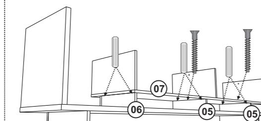
Fixar a peça 07 nas peças 05 com Cavilha e Parafuso 5x50.
