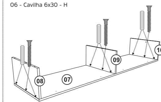
Fixar as peças 08, 09 e 10 na peça 07 com Cavilha e Parafuso 5x50.
