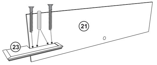
Fixar a peça 23 na peça 21 com Parafuso 5x50 e Cavilha.
