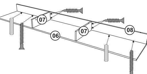
Fixar a peça 08 na peça 06 com Cavilha e Parafuso 5x50 e nas peças 07 com Parafuso 5x35 com ponta.
