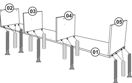
Fixar as peças 02, 03, 04 e 05 na peça 01 com Parafuso 5x50 e Cavilha.
