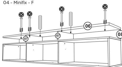
Fixar a peça 06 nas peças 07 com Minifix e Cavilha, e fixar na peça 08 com Minifix.
