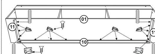
Fixar as peças 11 na peça 01 com Cavilha e Suporte angular e Parafuso 3,5x12 flangeado. Fixar a peça 10 na peça 01 com Suporte angular e Parafuso 3,5x12 chato.
