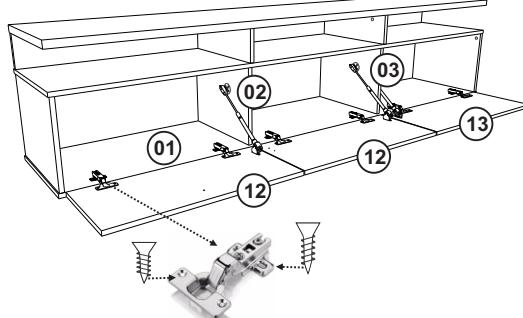
Fixar as Dobradiças nas portas 12 e 13 com Parafuso 3,5x12 e na peça 01 com Parafuso 3,5x12.
