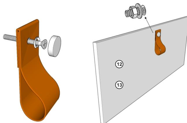
Dobrar a fita de Couro e encaixar o Parafuso 4x30 e fixar a Tampa no Parafuso.
