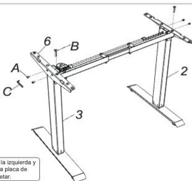
Primero use tornillos (B) para conectar la placa de soporte (6) con la izquierda y columnas derechas (2)(3), luego conecte los orificios laterales de la placa de soporte con los tornillos (A), usando la llave allen 5x5 (C) para apretar.
