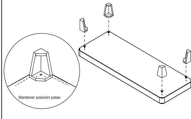
3 Con la ayuda de un destornillador instalar cada pata haciendo coincidir el perno con la perforación de la base, luego fijar la pata a la posición correcta con los tornillos fijación.
