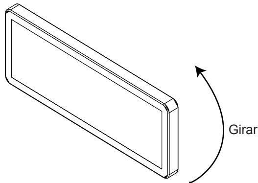
2 Poner las patas en la posición indicada (tal como se muestra en la figura) para proceder a instalar
