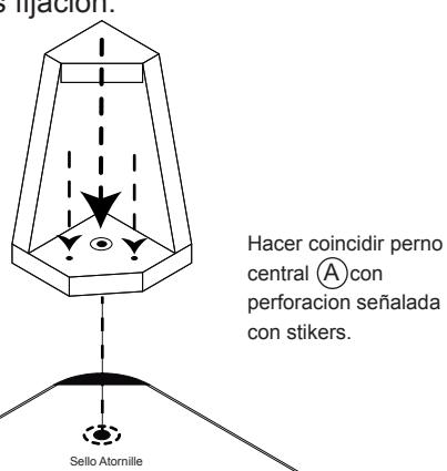
4 Asegurarse que las patas queden bien atornilladas (perno central y tornillos de fijación) y girar la base a la posición correcta.
