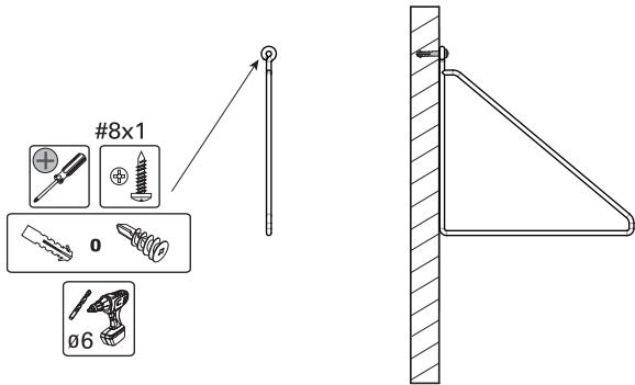
Definir posición del 1er soporte en el muro, marcar perforación para luego perforar y fijar con tornillo.
