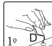
Se debe agregar pegamento a los orificios para pasadores en la parte 02
