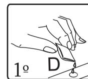
! Se debe agregar pegamento a los orificios para pasadores en la parte 07
