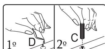
SE DEBE AGREGAR PEGAMENTO A LOS ORIFICIOS PARA PASADORES EN LA PARTE 3, 4
