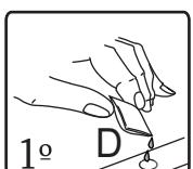
Se debe agregar pegamento a los orificios para pasadores en la parte 1, 2, 3
