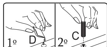
Se debe agregar pegamento a los orificios para pasadores en la parte 5.
