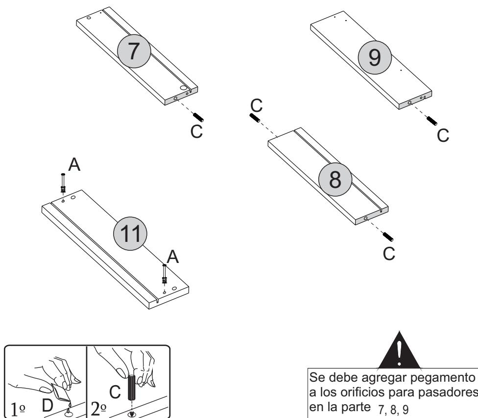
Se debe agregar pegamento a los orificios para pasadores en la parte 7, 8, 9
