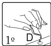
Se debe agregar pegamento a los orificios para pasadores en la parte 1, 2
