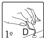
Se debe agregar pegamento a los orificios para pasadores en la parte 1, 2, 4
