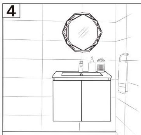
6-Una vez fijo el mueble se instala la cubierta con la grifería.
