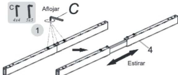
Afloja los tornillos (4) con una llave 4x4(C), luego Puedes extender la viga lo que necesitas.
