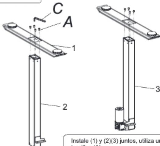
Instale (1) y (2)(3) juntos, utiliza una llave de 5 x 5 (C) para apretar los tornillos (A).
